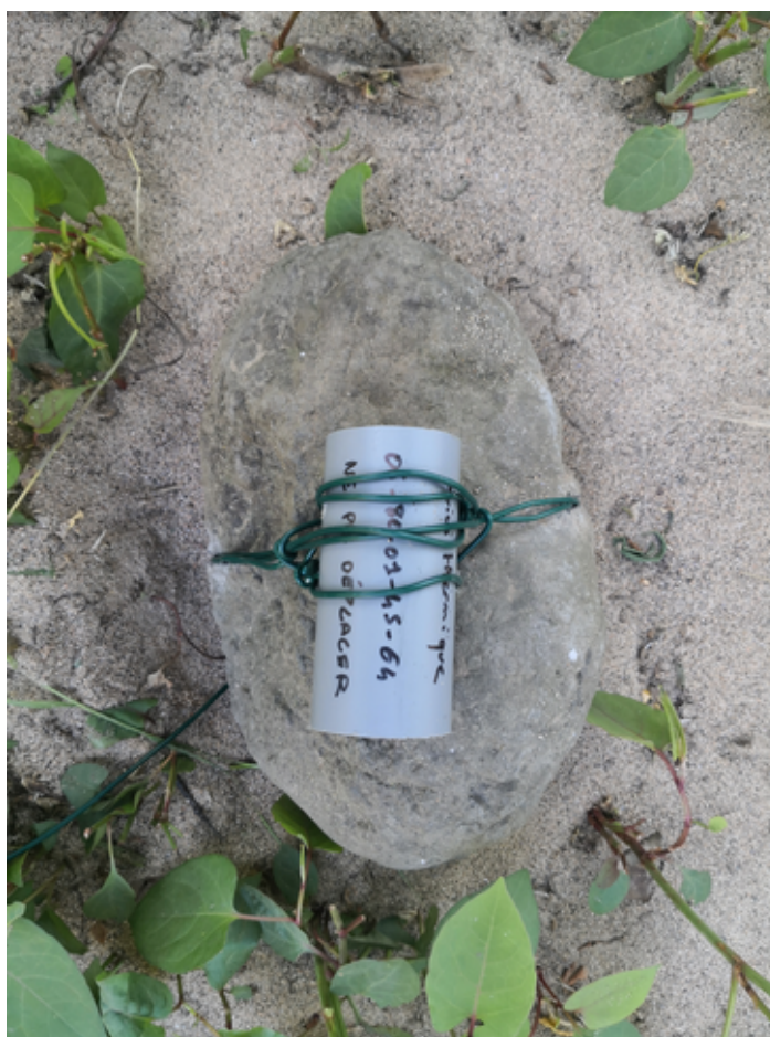
Figure 1: Lestage d'une sonde thermique avant immersion
